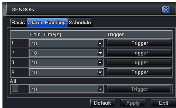
4-20. Ábra: riasztás beállítás – érzékelés - riasztáskezelés
